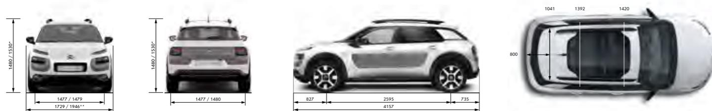
Volume de coffre : 358 litres (Normes VDA 210) - \* Hauteur sans barres de toit / avec barres de toit - \*\* Largeur véhicule / largeur avec rétroviseurs déployés.
